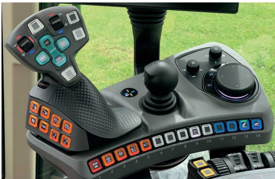
Fig. 7 Il joystick multifunzione è un accessorio ormai irrinunciabile, dove viene concentrato il controllo delle più importanti e ricorrenti funzioni nella gestione della macchina. Gli altri comandi sono spesso raggruppati in zone omogenee per funzione, che sfruttano la cosiddetta «logica colore» per un'immediata comprensione del loro azionamento
