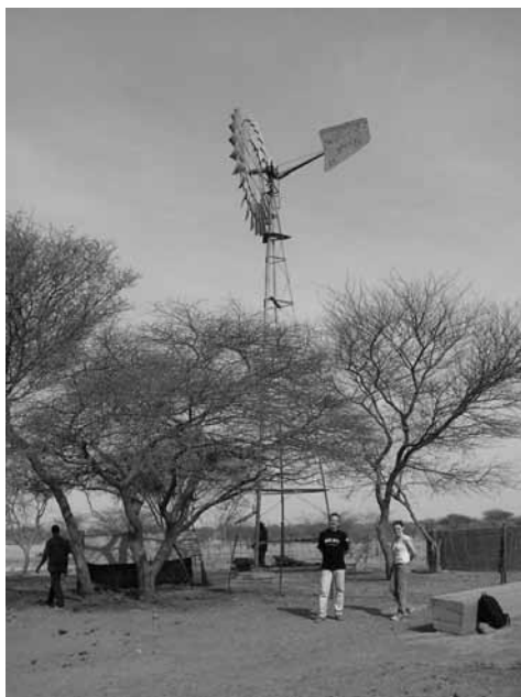
Fig. 14 Aerogeneratore per il pompaggio meccanico dell'acqua in Niger
