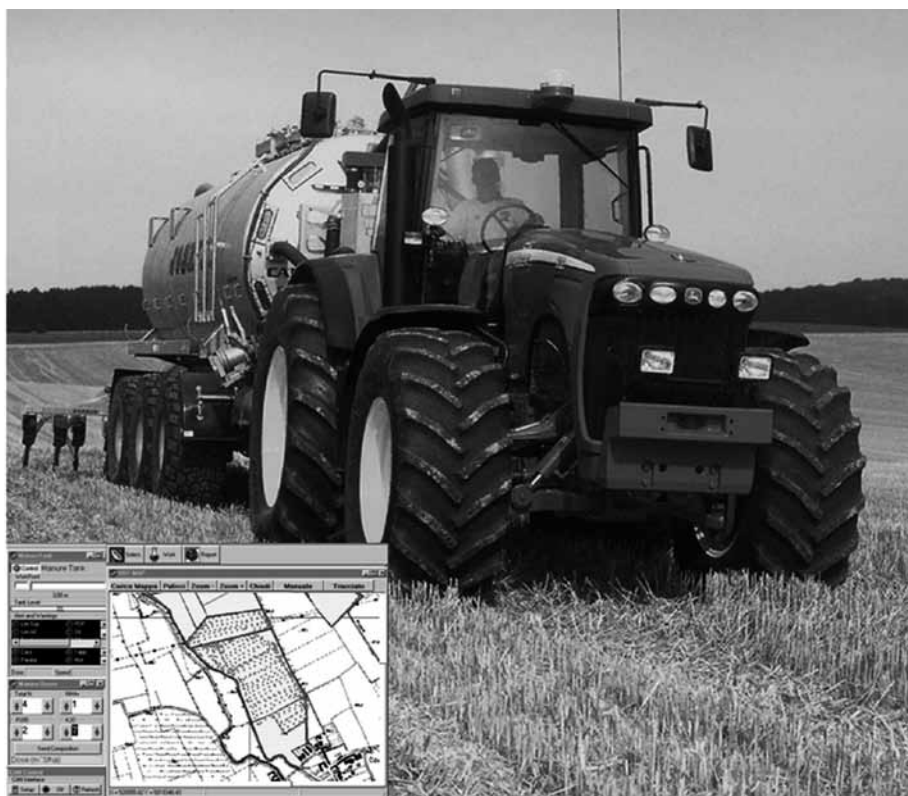
Fig. 11 Monitoraggio della distribuzione dei liquami con sistemi GPS
