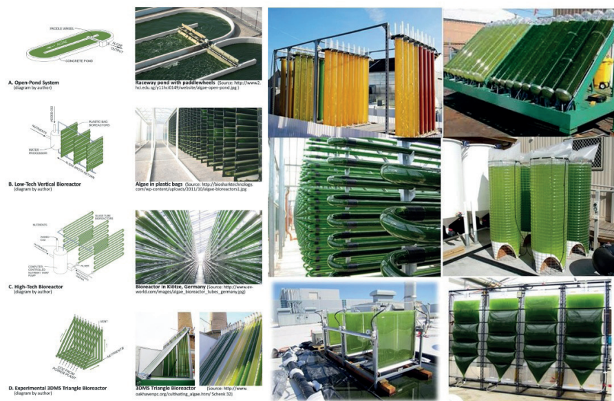
Fig. 18 Tipologie disponibili di foto-bioreattori per la cattura di \text{CO}_2 da emissioni industriali
