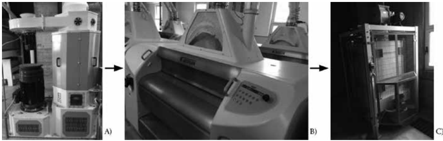
Fig. 1 A) Decorticatrice verticale; B) Laminatoio; C) Turboseparator e micronizzatore
