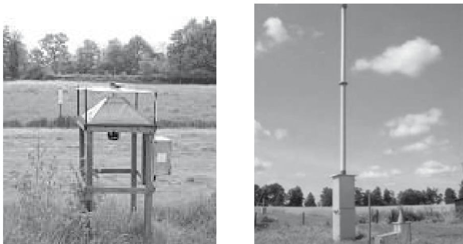
Fig. 5 Trappola luminosa (sinistra) e torre di aspirazione (destra) installate presso il centro di ricerche di Rothamsted (Harpenden, GB). Entrambi i dispositivi sono parte di una rete europea di monitoraggio delle popolazioni di insetti
