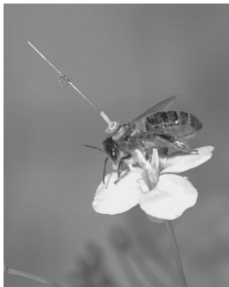
Fig. 4 L'uso di transponder RFID miniaturizzati permette di seguire contemporaneamente le traiettorie di più individui in campo
