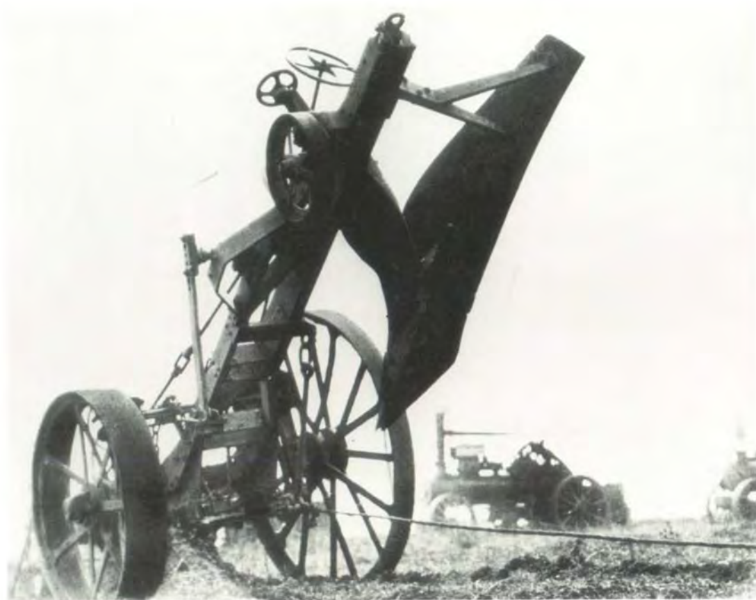
2 - Aratro monovomere a bilancere per lavorazioni profonde, azionato da due locomobili a vapore, 1912
