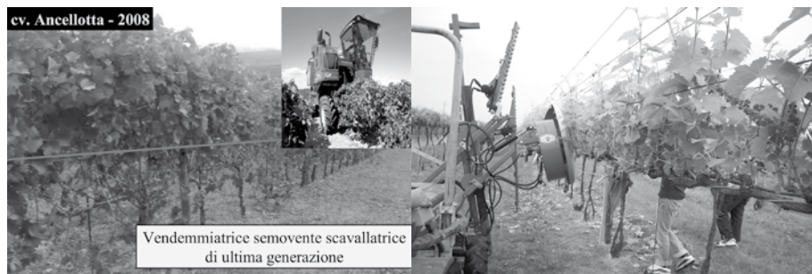
Foto 1 A sinistra, una vendemmiatrice scavallatrice di ultima generazione al lavoro su un filare di Ancellotta. Si noti l'integrità della chioma al di sopra della linea grigia. A destra un particolare di defogliazione meccanica precoce su Sangiovese
