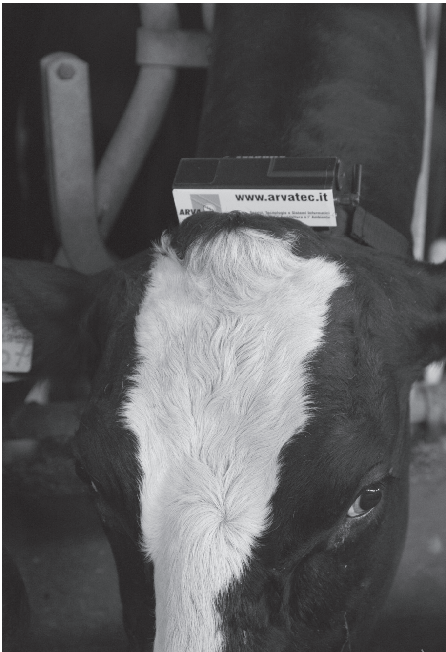
Fig. 9 Prototipo di collare sensibilizzato con tecnologia GPS
