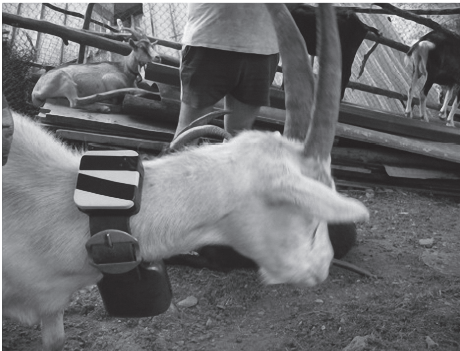
Fig. 7 Il collare GPS sviluppato per il tracciamento del gregge
