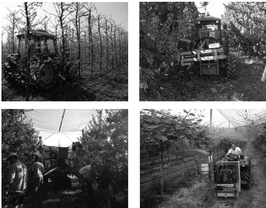
Foto 5-8 La meccanizzazione delle operazioni colturali, laddove esistono adeguati supporti tecnologici, sta diventando presupposto per ridurre i costi di produzione e ottimizzare le rese del frutteto. Dall'alto a sinistra in senso orario: diradamento meccanico su pesco; potatura estiva meccanizzata su pesco; impollinazione forzata meccanizzata in un impianto di actinidia; carro raccolta con nastri agevolatori per il trasporto dei frutti
