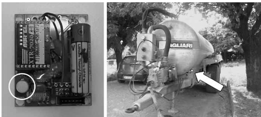
Fig. 4 Il circuito elettronico del trasmettitore di codice con in evidenza l'interruttore di vibrazione. A destra, indicato dalla freccia, il punto di installazione del trasmettitore su un carrobotte
