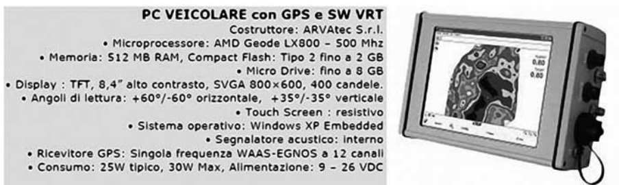
Fig. 5 Caratteristiche tecniche del componente PC completo di scheda GPS
