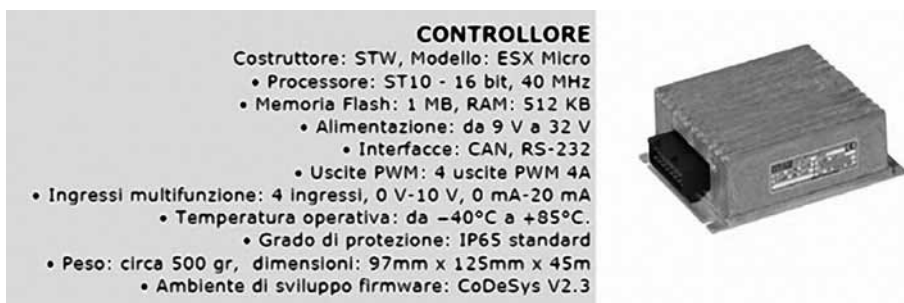
Fig. 7 Caratteristiche tecniche del componente CM
