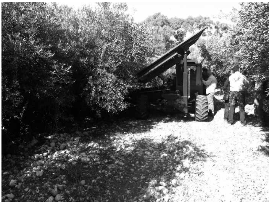
Fig. 8 Raccolta meccanica di oliveto intensivo in parete con vibratore da tronco e struttura di intercettazione tipo Side by side
