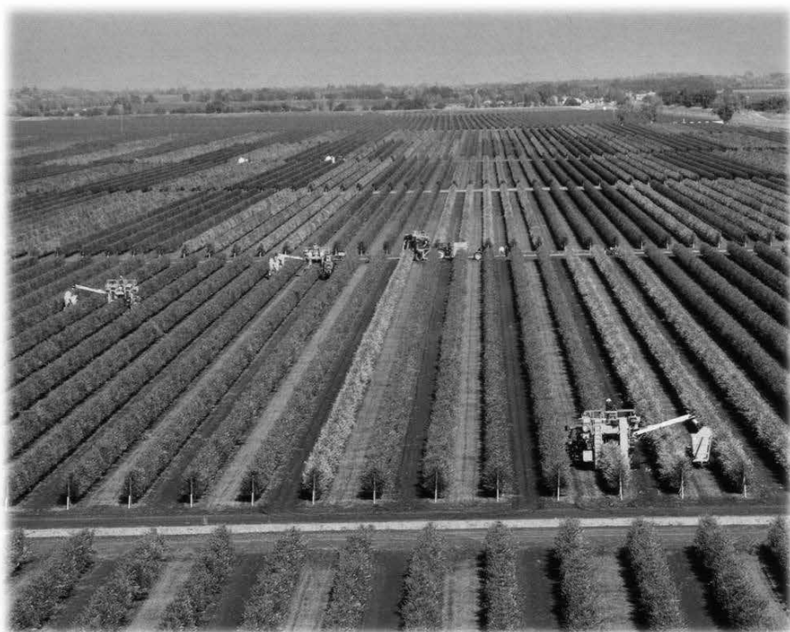
Fig. 5 Raccolta meccanica di oliveti superintensivi con macchina scavallatrice
