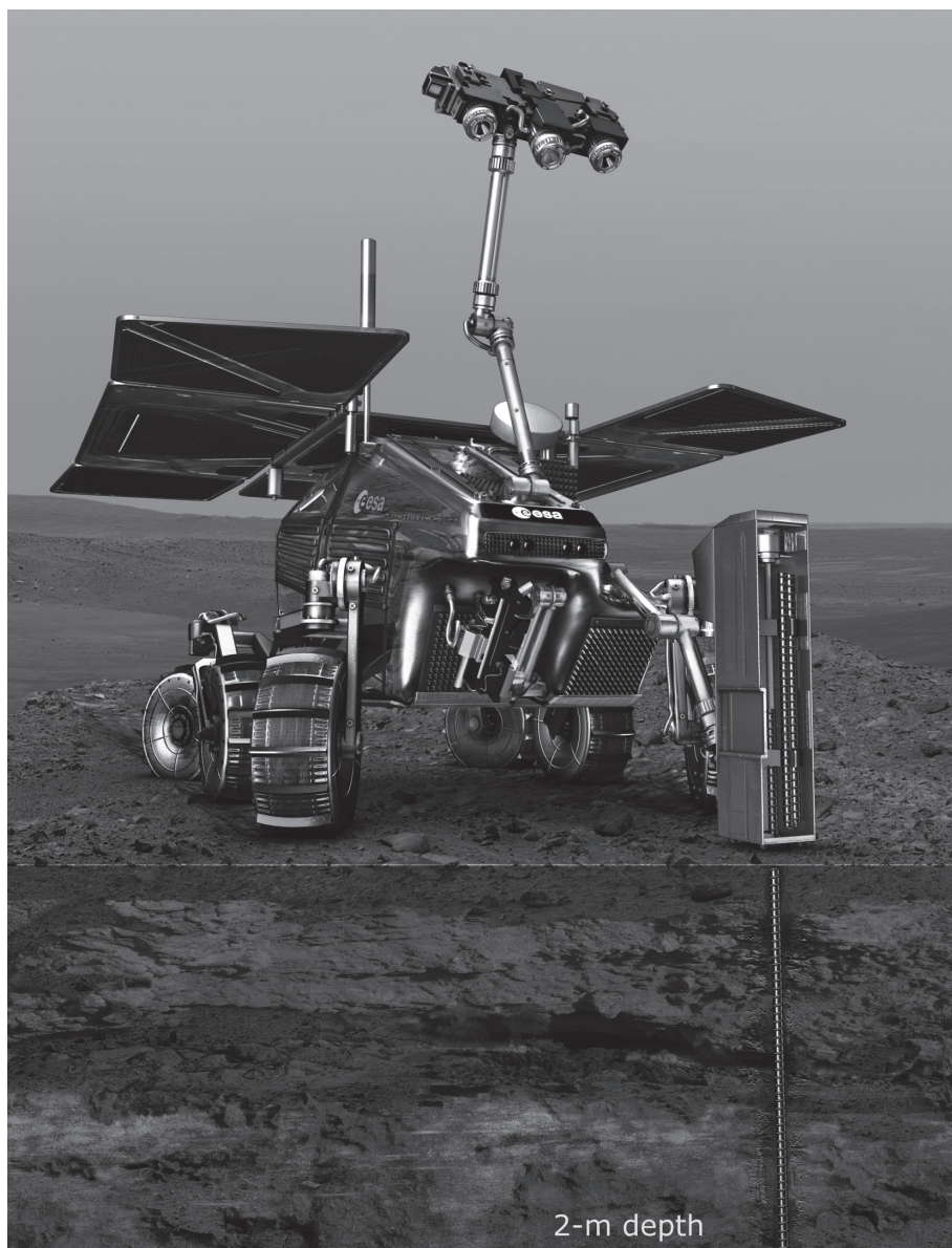
Fig. 2 Visione artistica del Rover ExoMars. È possibile vedere il trapano in grado di prelevare campioni a una profondità di 2 metri nel suolo marziano (Credito ESA)
