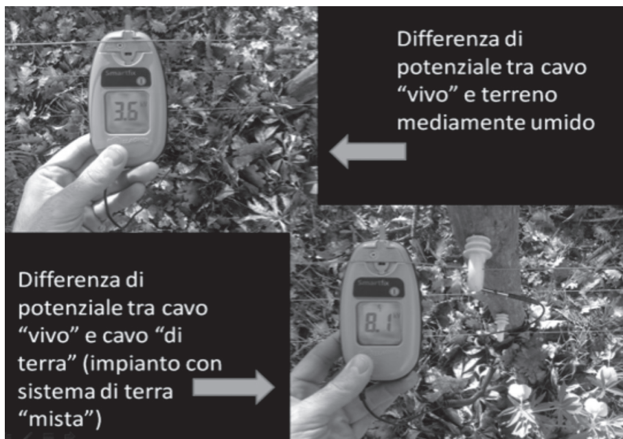
Fig. 10 Differenza di efficienza dell'impianto nel caso di montaggio diverso dell'impianto di terra. Con lo schema di montaggio di terra utilizzato si amplifica l'efficienza dell'impianto, soprattutto in caso di terreno asciutto
