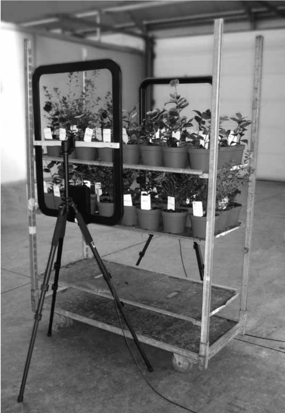
Fig. 3 Identificazione in lettura dinamica attraverso un varco RFID ad alta frequenza di piante in vaso con transponder in etichette
