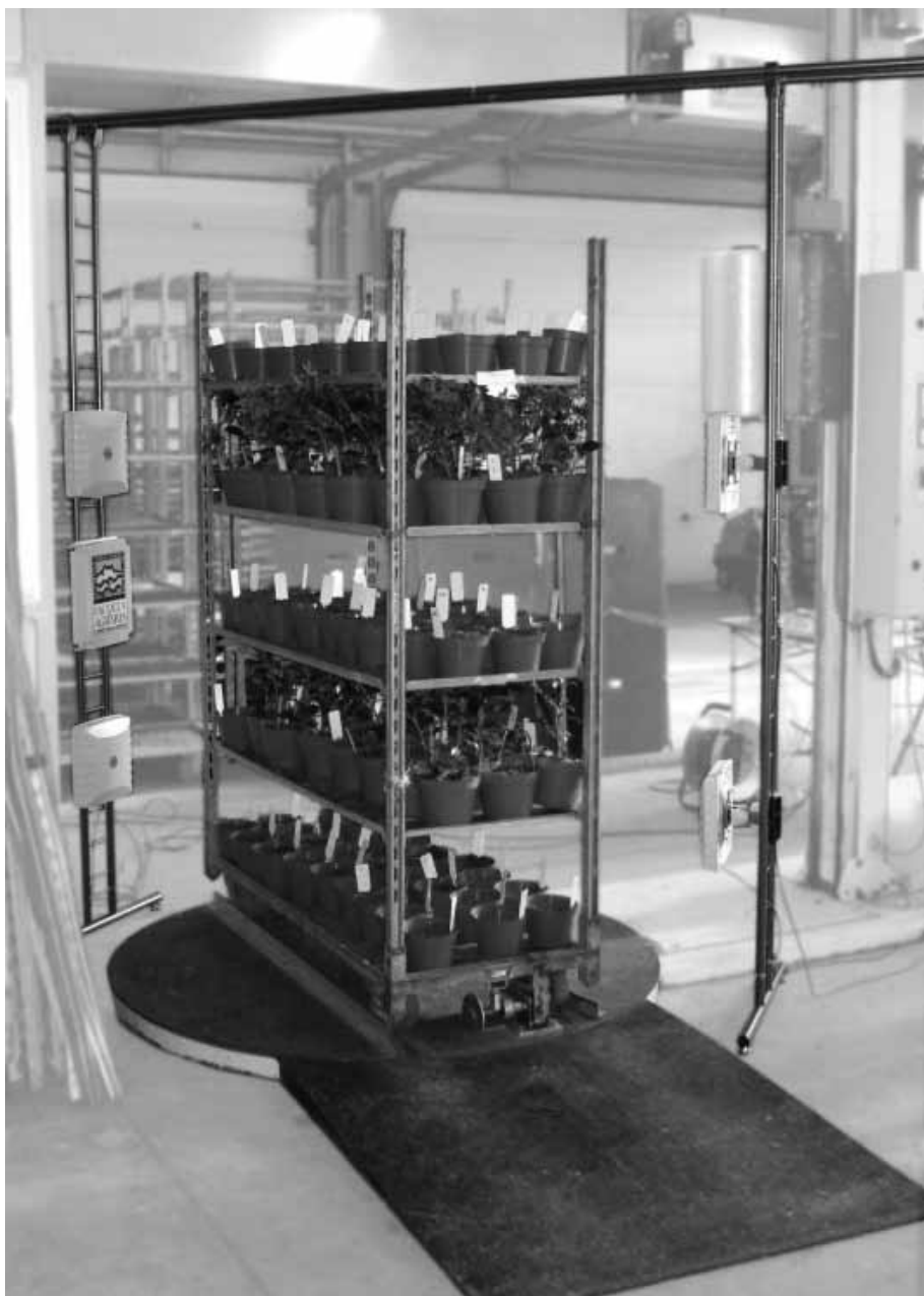
Fig. 5 Lettura dinamica di 129 piante in vaso identificate con etichette UHF durante la fasciatura prima della spedizione
