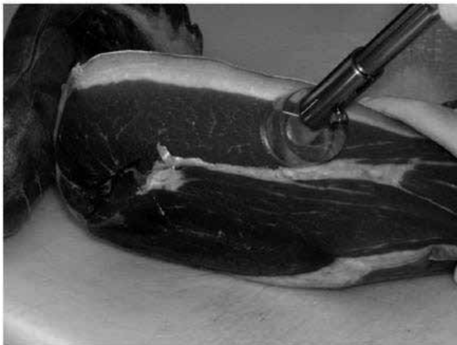
Fig. 6 Lettura tramite fibra ottica del muscolo Bicipite femorale del prosciutto (adattato da Bellatti et al., 2005)
