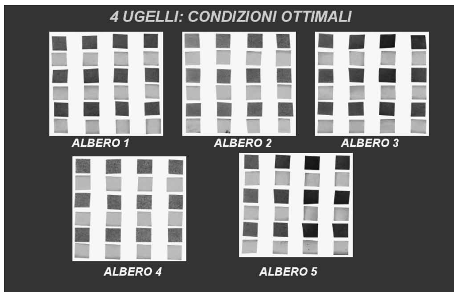
Fig. 13 Prove sperimentali di spruzzo con cartine idrosensibili ( h=0.8 m; p_A = 1.9 bar; p_W = 0.7 bar; t_1 = 14.8 s; t_2 = 18 s; numero di passate = 2)
