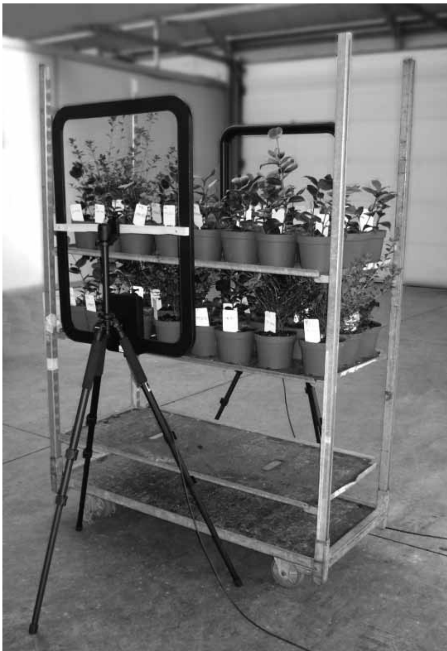
Fig. 3 Identificazione in lettura dinamica attraverso un varco RFID ad alta frequenza di piante in vaso con transponder in etichette
