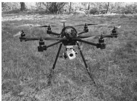
Fig. 1.7 Il quadricottero con la termocamera installata, in posizione di riposo.
