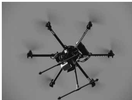
Fig. 1.2 L'esacottero custom appositamente predisposto per trasportare una Termocamera radiometrica Flir Tau2 336.
