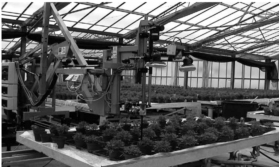
Fig. 1 Il primo prototipo di cella robotizzata realizzata dal D.E.I.A.F.A. basato su struttura cinematica a pantografo
