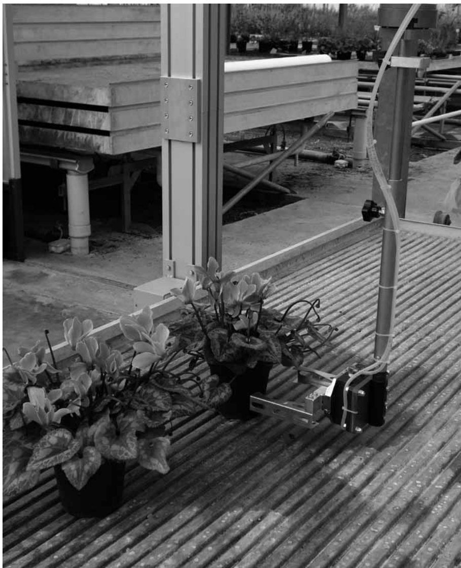
Fig. 3 Pinza pneumatica per la movimentazione dei vasi connessa al mandrino del polso del secondo prototipo di cella robotizzata realizzata dal D.E.I.A.F.A.
