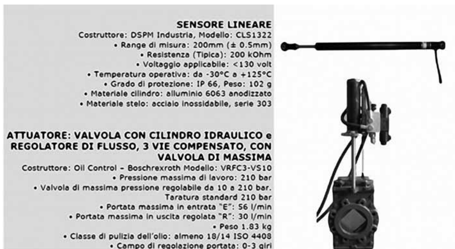
Fig. 8 Caratteristiche tecniche della valvola di regolazione completa di sensore lineare
