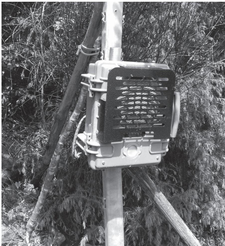
Fig. 2 Dissuasore Acustico Faunistico "Alarm Guard"
