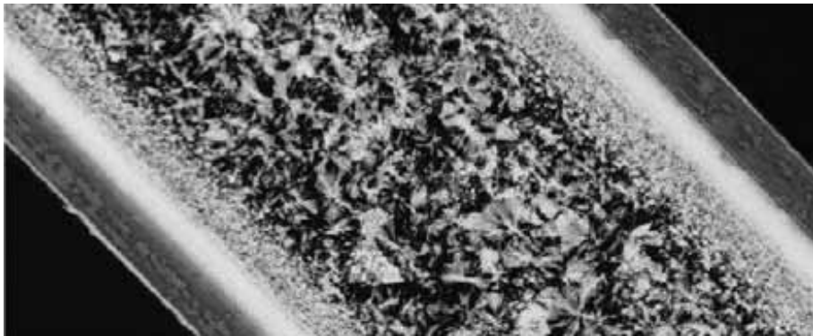
Fig. 4 Distribuzione morfologica di un manufatto ottenuto per stampaggio a iniezione
