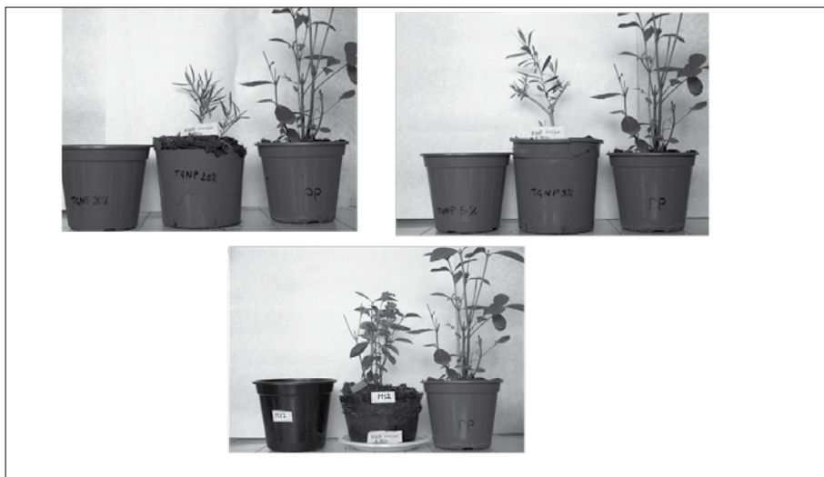
Fig. 5 Valutazione dello stato di degradazione dei vasi in TGNP 5% e 20%, M12 e PP utilizzati per le coltivazioni di piante ornamentali
